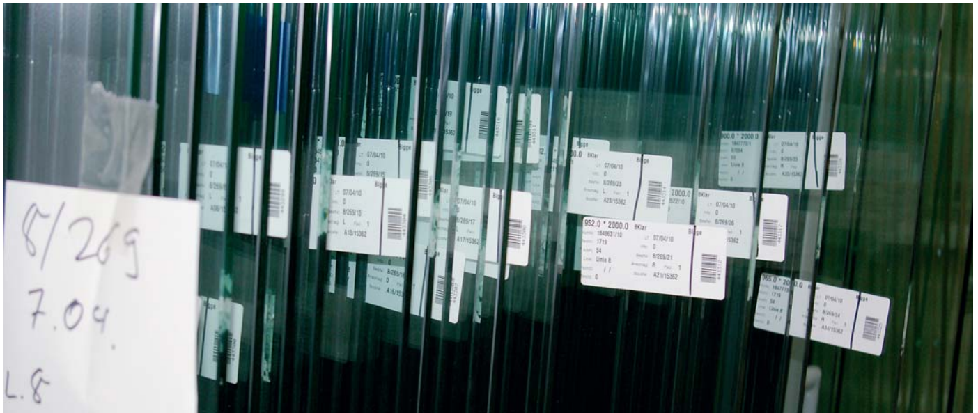
6 bis 8 mm Sicherheitsglas, der „Stoff“, aus dem HSK Duschräume baut und damit im Sinne des Fachhandwerkers so „schnell und zuverlässig“ ist, wie es das Tagesgeschäft vor Ort verlangt. (Fotos: Martin)
